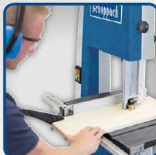
Hærdet præcisions-3-rolleføring over og under bordet
