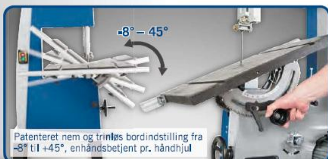
Enestående skærehøjde 205 mm og udladning 306 mm
