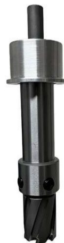
Kit #3 med lejbøsning (Ø 43 mm.), med spindel for 19 mm. Weldon-skaft til 25 mm DOC, op til Ø 40 mm.
